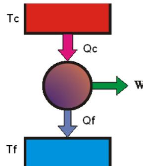
Figura 13: Máquina Térmica
