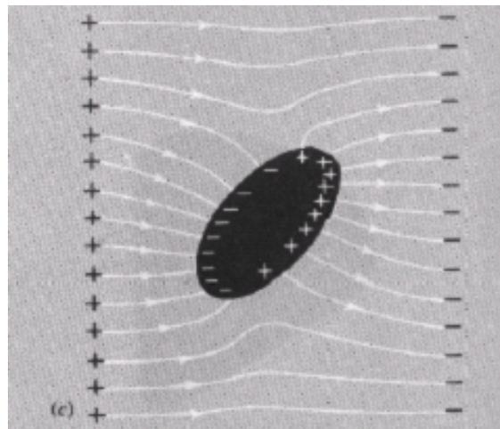
Figura 1: Líneas de campo deformadas por un conductor
