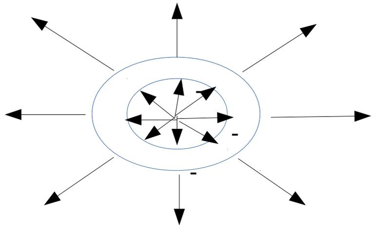
Analícemos físicamente que es lo que ocurre : La carga puntual  $q$  genera campo, al entrar en el conductor ese campo atrae las cargas negativas hacia la superficie A y repele las positivas hacia la superficie B, de modo de anular el campo en el conductor . Observemos que el campo que queda es el que genera la carga  $q$ , adentro de todo ( $r < a$ ) y afuera de todo ( $r > b$ ).
