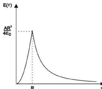
Figura 4: Módulo del campo eléctrico en función de la coordenada radial
