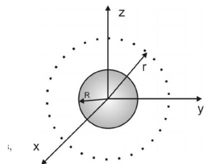
Figura 2: Superficie de Gauss (punteada) en la región  $r > R$
